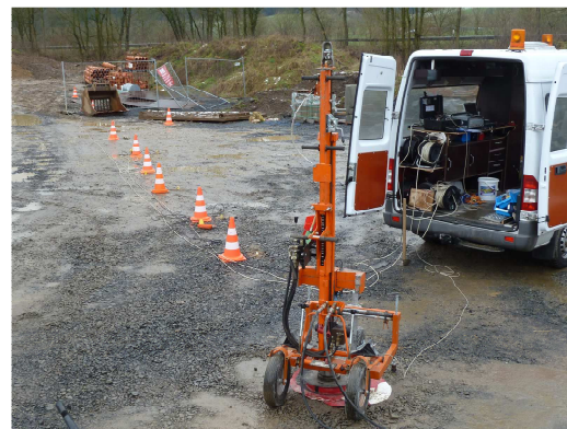
Admittanz-Messung mit Dynpact® und Geophonen
