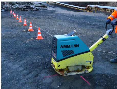
Ausbreitungsmessung der Erschütterungen einer Rüttelplatte mit Geophonen
