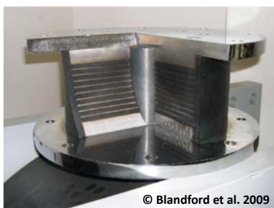
Bewehrtes Elastomerlager mit Bleikern sowie Kopf- und Fußplatte © Blandford et al. 2009
