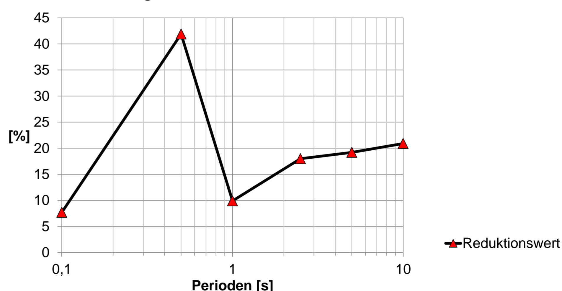
Reduktionsfaktor als Funktion der Bauwerksperiode für das Beben von Whittier Narrows, USA, 1.10.1987
